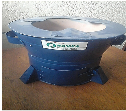
Photo : Modèle de foyer amélioré Jiko (Moseka) à vulgariser et diffuser au quartier Kivu/Masina.
