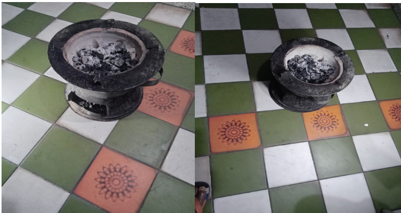
Photo 1. Un foyer amélioré-type identifié auprès d'un ménage du Quartier Kivu/Masina
